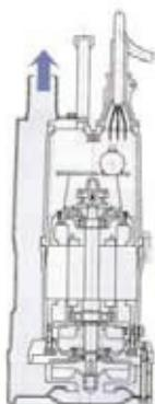
L'eau pompée refroidit le moteur et est refoulée comme illustré ci-contre. Le refroidissement du moteur est également assuré en pompant très peu d'eau. Le refolement par le dessus permet l'accès à des espaces réduits.
